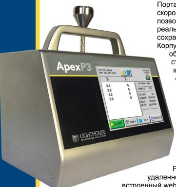
Портативные счётчики частиц со скоростью отбора проб 28,3 л/мин АрехР позволяют получать данные, как в реальном времени, так и просматривать сохраненные результаты измерений. Корпус из нержавеющей стали легко
